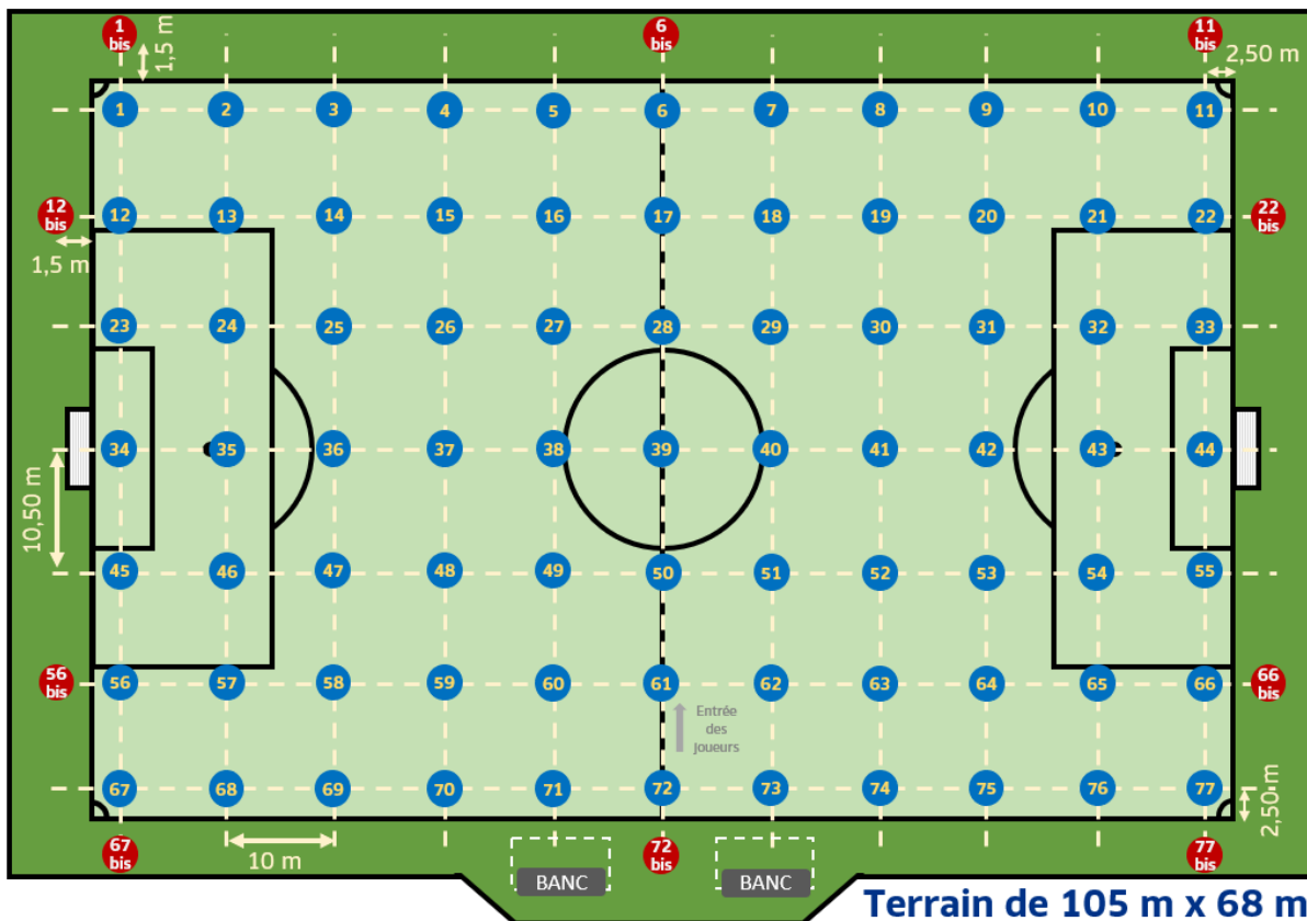
Figure n°1 - Mesure des éclairages, niveaux E1 à E3
